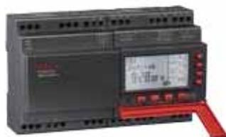
Hauptuhr zur Durchführung von Zeitsteuerungen im VARIODYN® D1-System. Die Hauptuhr wird über ein UIM (Art.-Nr. 583331.21) an das VARIODYN®-System angeschlossen. Mit dem Funkempfänger (Art.-Nr. 583391) kann eine DCF77-Zeitsynchronisation der Hauptuhr durchgeführt werden.
