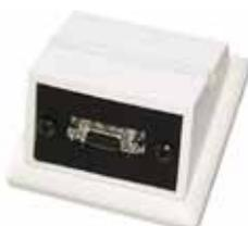
UP-Dose für DIGISystem Tischsprechstellen mit verriegelbarer 9-poliger D-Sub-Buchse inklusive EMI-/RFI-Filter. Schnell anschließbar durch Schraubklemmen. Der Buchsenauslass kann wahlweise senkrecht oder 30° geneigt erfolgen. Komplett mit 1fach Rahmen passend zum Schalterprogramm GIRA System 55 reinweiß. Mittels AP-Gehäuse (Art.-Nr. 581329) auch auf Putz zu verwenden.
