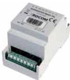
Das DOORMASTER SMART PAL Telefoninterface dient zur Einspielung von Durchsagen über eine analoge Telefonanlage in das VARIODYN® D1 Sprachalarmsystem. Über die Telefonanlage können bis zu 4 unterschiedliche Rufkreise bzw. Bereiche angesprochen werden. Hierfür stehen 1 + 4 Steuerkontakte für Einschaltung und/oder Zonenauswahl zur Verfügung.
