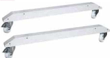
Schwerlastrollsockel zur Aufnahme eines Standchranks ohne Schwenkrahmen Art.-Nr. 584910. Die Rollvorrichtung besteht aus zwei Schwerlastschienen mit Rollen, die rechts und links unter den Standschrank geschraubt werden. Aufgrund der erforderlichen Standfestigkeit erhöht sich die Tiefe des Standchranks auf 120 cm.
