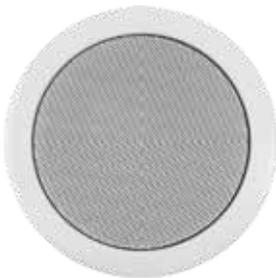
Der AB-Bajonettdeckenlautsprecher (EDL-EN 06-200/T) ist mit zwei voneinander unabhängigen Chassis und Transformatoren konstruiert und ermöglicht die kostengünstige Versorgung über zwei getrennte (A/B-)Leitungen.
