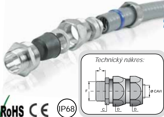
převlečná matice těsnicí kroužek ochranná koncovka tělo vývodky podložka těsnění tělo vývodky
