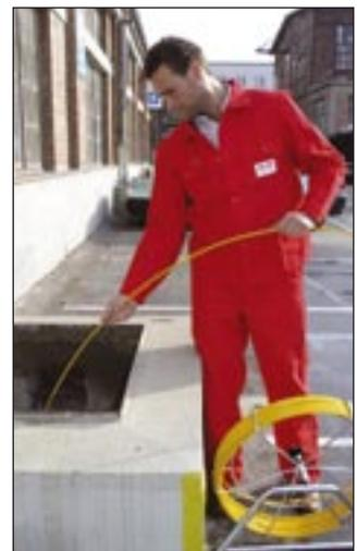
**Kabel-Jet**, Kabeleinziehgerät mit Polykat®-Glasfibreinziehband Ø 7,2 mm. Anfangshülsen mit Gewinde M12 an beiden Bandenden. Verzinktes Stahlrohrgestell, klappbar, integrierte Bremse. Mitgeliefertes Zubehör:
