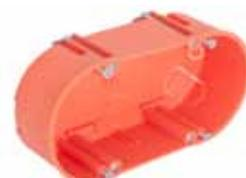
**HWDZ**, krabica pre 2 prístroje; oranžová (RAL 2004), vzdialenosť skrutiek 60 mm, potrebný inštalačný otvor 2x Ø 68 mm, vonkajší lem krabice 71x142 mm, pre podklady hrubé 7-35 mm, max. pripojenie 5 ochranných rúrok Ø 20 mm a 3 káblor, s vodiacou drážkou pre zasunutie oddel'ovacích prepážok a predznačené body pre frézovanie otvorov
