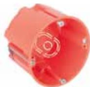
**HWD**, rozbočovacia prístrojová krabica; oranžová (RAL 2004), vzdialenosť skrutiek 60 mm, potrebný inštalačný otvor Ø 68 mm, vonkajší lem krabice Ø 71 mm, pre podklady hrubé 7 - 35 mm, max. pripojenie 4 ochranných rúrok Ø 20 mm, 2 ochranných rúrok Ø 25 mm a 4 káblor
