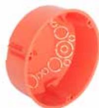
**HWAD**, rozbočovacia prístrojová krabica; oranžová (RAL 2004), potrebný inštalačný otvor Ø 121 mm, vonkajší lem krabice Ø 126 mm, pre podklady hrubé 7-35 mm, max. pripojenie 9 ochranných rúrok Ø 20 mm, 4 ochranných rúrok Ø 25 mm a 12 káblor, s vodiacou drážkou pre zasunutie oddel'ovacích prepážok
